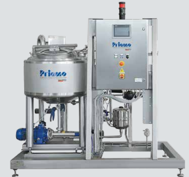
Impianto per la produzione di yogurt classico o da bere con miscelazione di frutta in automatico e con trasferimento diretto al confezionamento.
